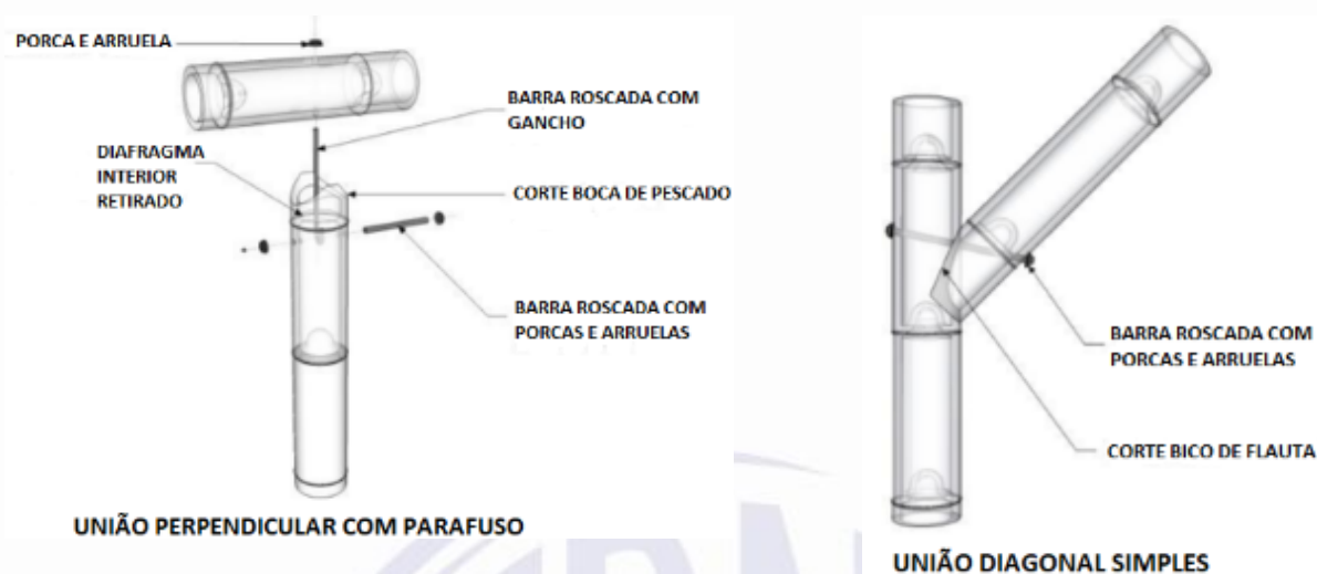
a) Ligação perpendicular com parafuso
