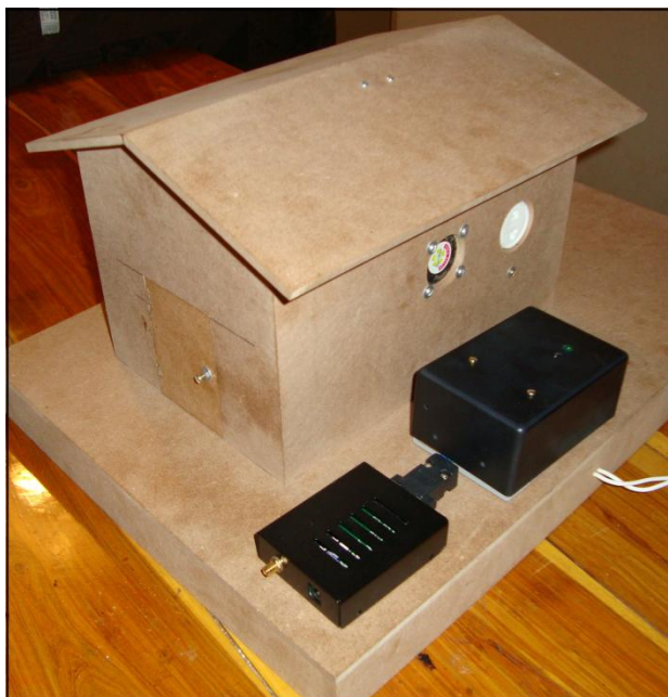
Figura 26 - Maquete, posicionamento do hardware e do modem GSM.
