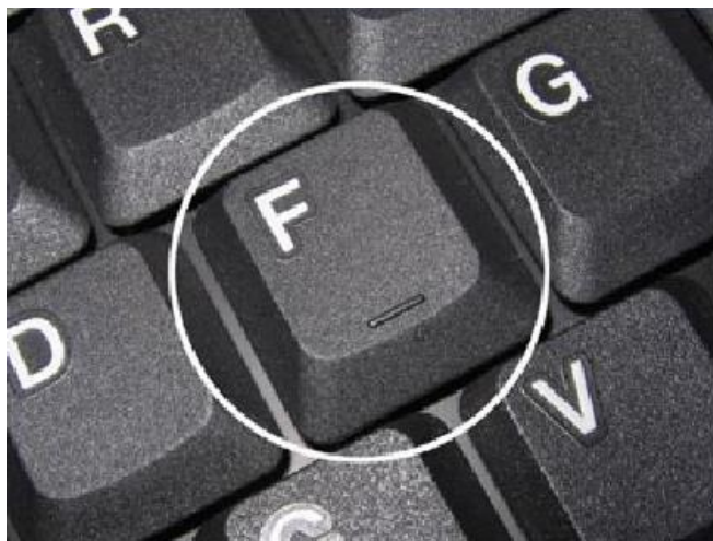
Figura 01 - Teclado de computador com a letra F e seu relevo na superfície.
