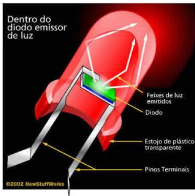
Figura 9 - Representação da estrutura básica de um diodo LED Fonte: ( http://oficinabrasilvirtual.blogspot.com.br/2010/12/led-diodo-emissor-de-luz.html ).
