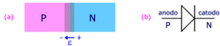
Figura 7 - (a) arranjo de um diodo (b) símbolo que representa o diodo Fonte: ( http://www.mspc.eng.br/electrn/semic_210.shtml ).
