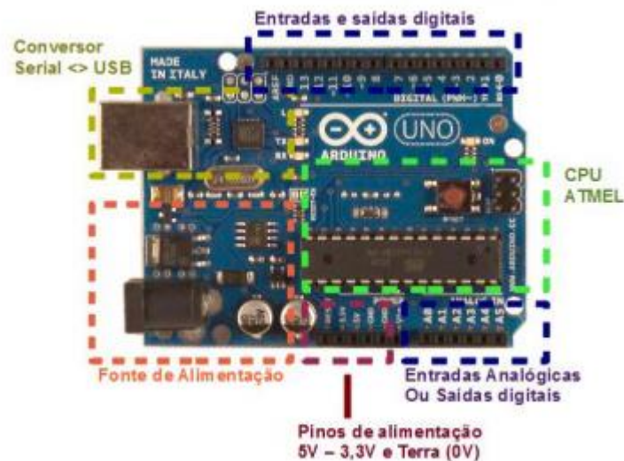
Figura 37 – Arquitetura do Arduino
