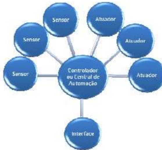
Figura 11: A arquitetura centralizada dos sistemas integrados.
