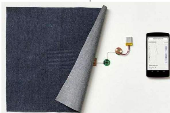
Figura 5: O toque no tecido da roupa é transmitido sem fio a dispositivos para controlar funções desses dispositivos.
