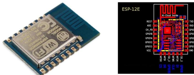
Figura 20: ESP-12E e seu circuito.
