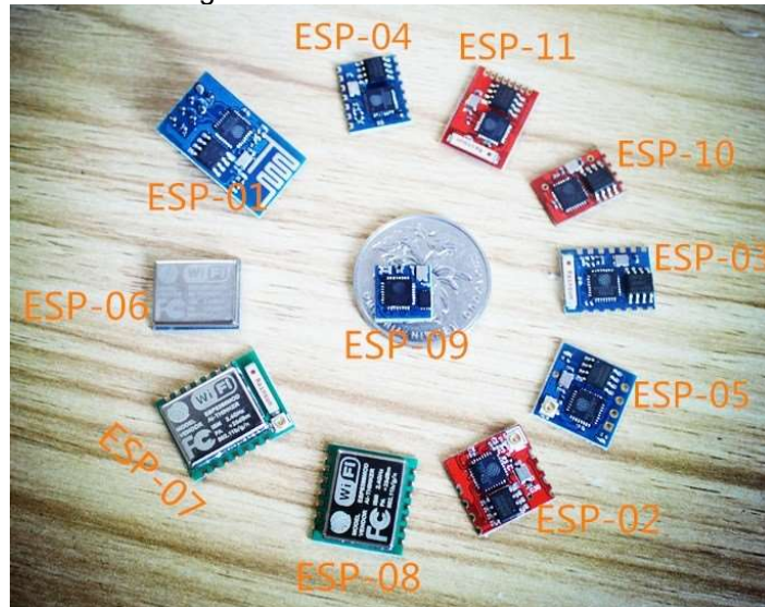
Figura 17: Variantes do ESP8266
