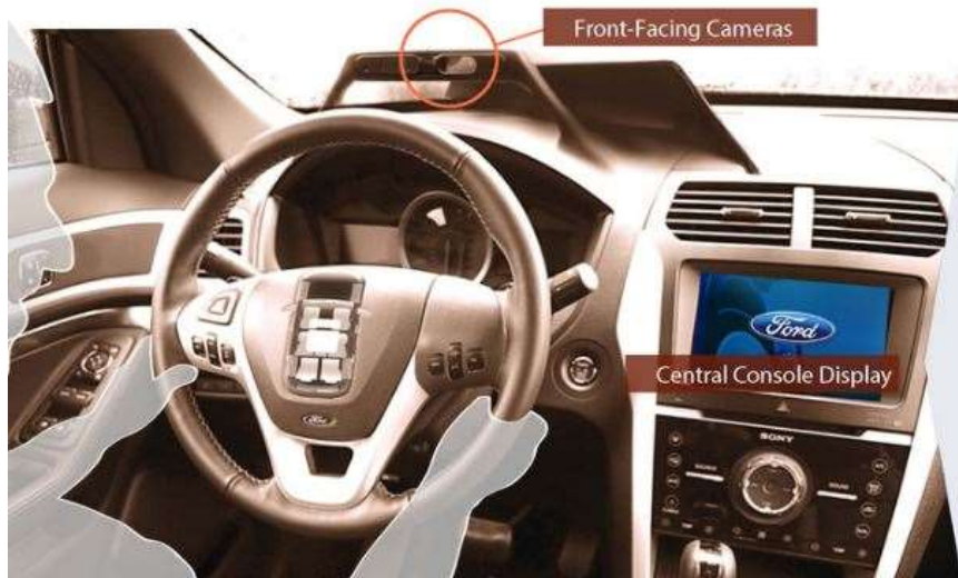
Figura 2: Representação do sistema Mobii, onde tem-se o carro com a câmera de reconhecimento facial e o painel de controle do sistema.
