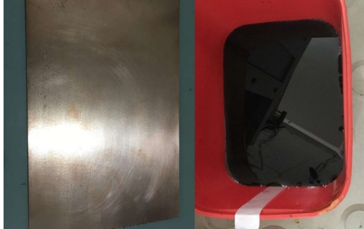
Figura 33: Placa de fenolite e percloroato de ferro em uma vasilha de plástico.
