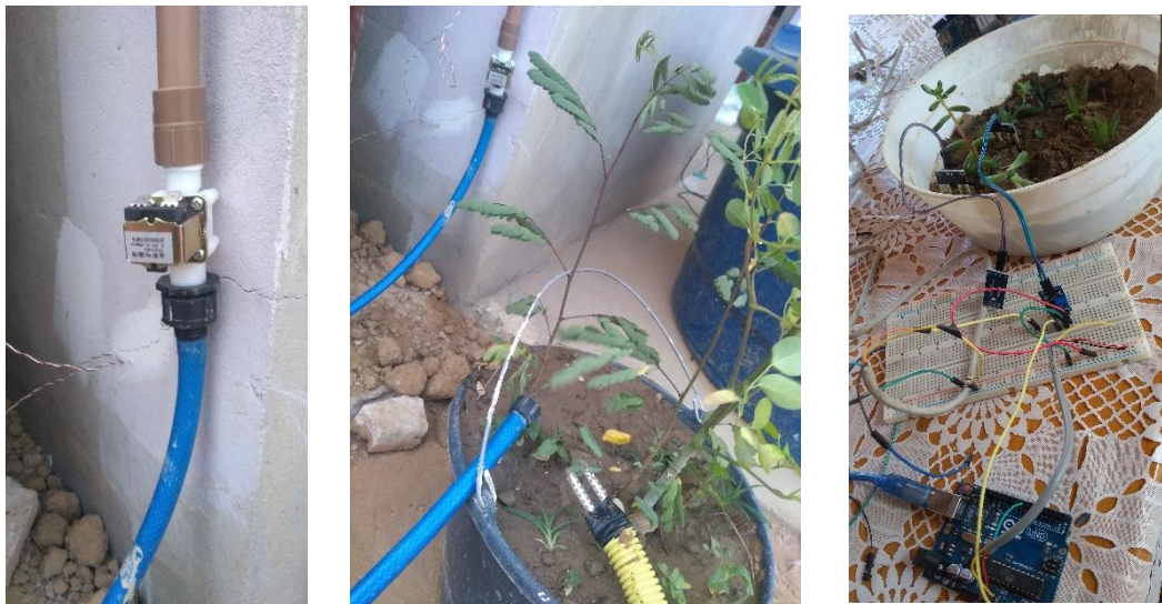
Figura 4.19: Sensor de umidade e valvula solenoide
