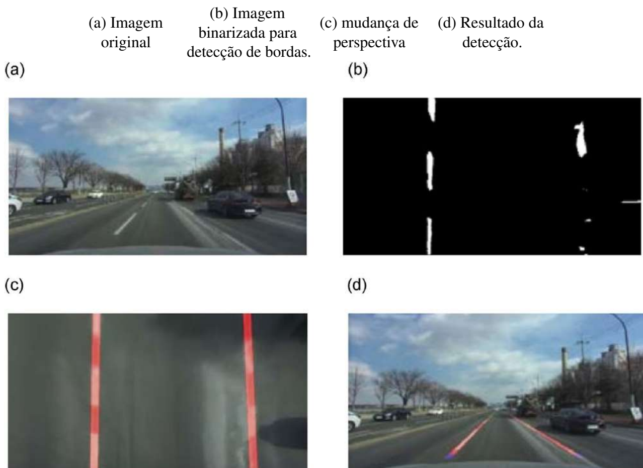
Figura 3 – Procedimento de detecção de linha de faixa (CHOI; PARK; JUNG, 2018).
