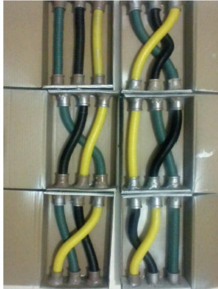
Vemos na figura 3.5 o interior de todas as seis caixas utilizadas, é visível a diferença entre as combinações de entradas e saídas de todas elas. Na saída de cada caixa (ou na saída da combinação entre elas) foi colocado um copo da cor do conduíte para que possa ser feita a análise do comportamento da bolinha de isopor em cada caixa.
