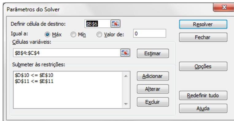
Figura 16 – Designação das células para receber as variáveis e submeter as restrições
