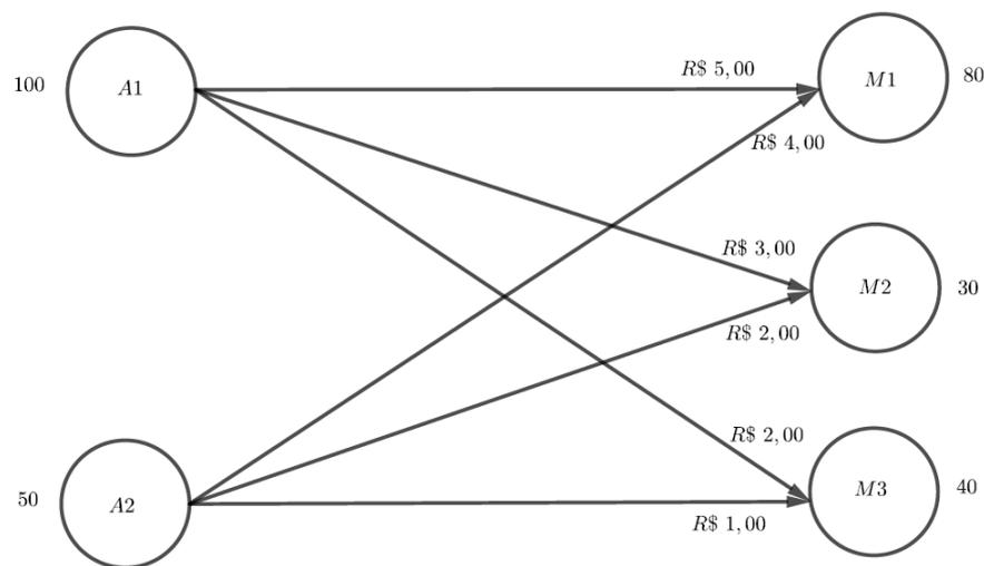
Figura 1 – Sistema de transporte com duas fontes de três destinos
