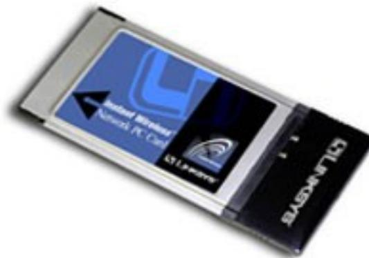
Figura 12 - Receptor sem fio PCMCIA
