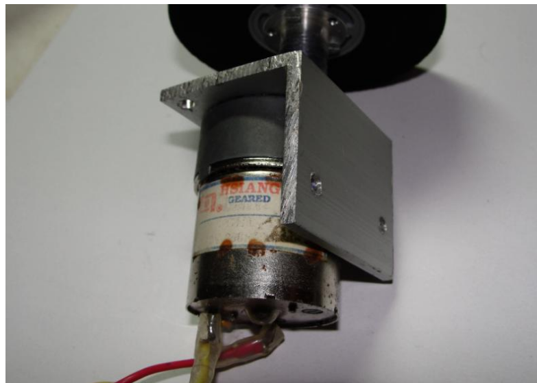
Figura 15: Estrutura de sustentação dos motores
