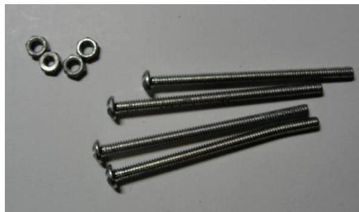
Figura 9: Parafusos e porcas de sustentação das placas
