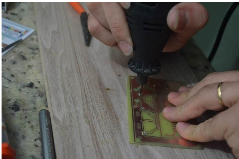
Figura 37: Perfurando a placa
