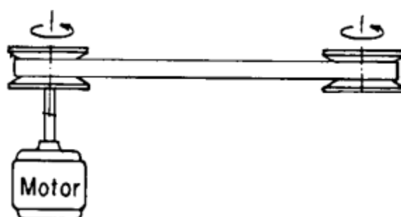
Figura 5: Polias com motor acoplado. Fonte: Sandin (2003, p.74).
