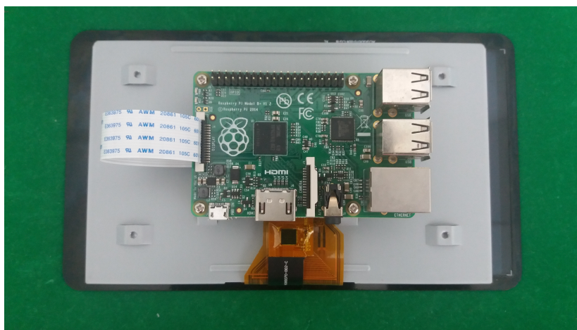
Figura 14 – Conexão do cabo de vídeo
