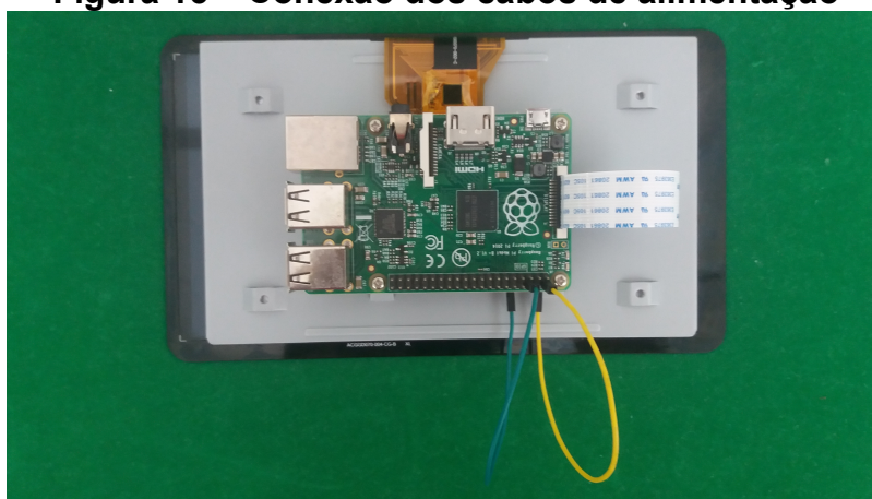
Figura 15 – Conexão dos cabos de alimentação
