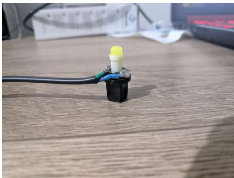
Figura 23 – Lâmpada LED Branca utilizada como Fonte de Iluminação.
