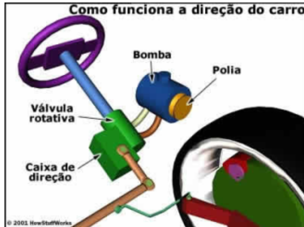
Figura 2.8: Funcionamento da direção hidráulica Fonte: (HYDRAUSYSTEM, 2010)
