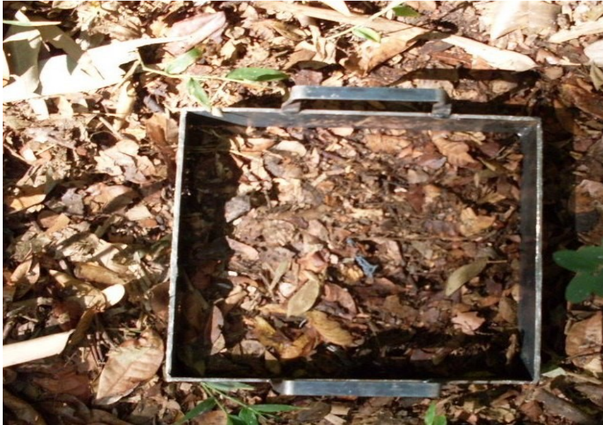
Figura 2 - Gabarito de ferro utilizado para coleta das amostras do banco de sementes do solo.
