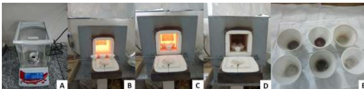
Figura 5 - Pesagem de aproximadamente 1 grama de carvão vegetal moído, peneirado e seco (A); Aclimação dos cadinhos em mufla, a 950°C, durante dois minutos (B); Transferência dos cadinhos para o interior da mufla, a 950°C, por nove minutos para determinação de materiais voláteis(C); Calcinação do carvão vegetal, a 600°C, durante seis horas, para obtenção das cinzas (D); Resíduos (cinzas) da decomposição térmica do carvão vegetal (E).
