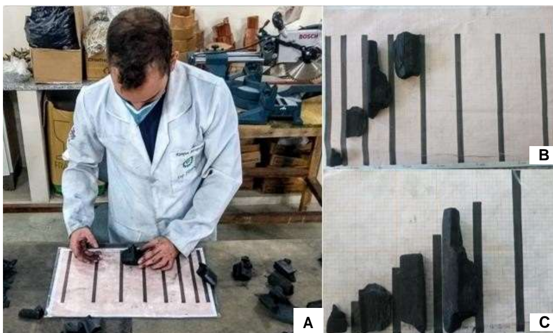
Figura 2 – Aplicação manual da metodologia em laboratório (A) para medição de largura (B) e tamanho (C).
