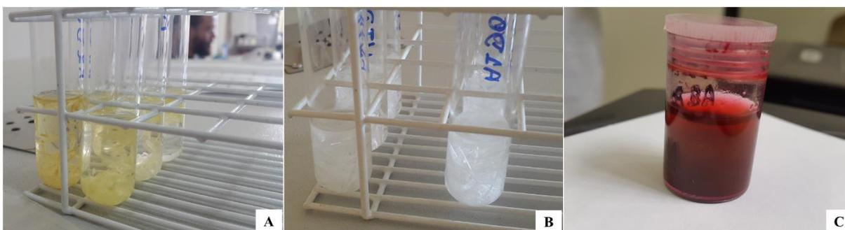
**Figura 3** - Fragmentos de madeira inicialmente imersos em solução macerante (A). Fibras imersas em solução macerante após 48 horas na estufa (B). Coloração das fibras dissociadas com o corante safranina (C).
