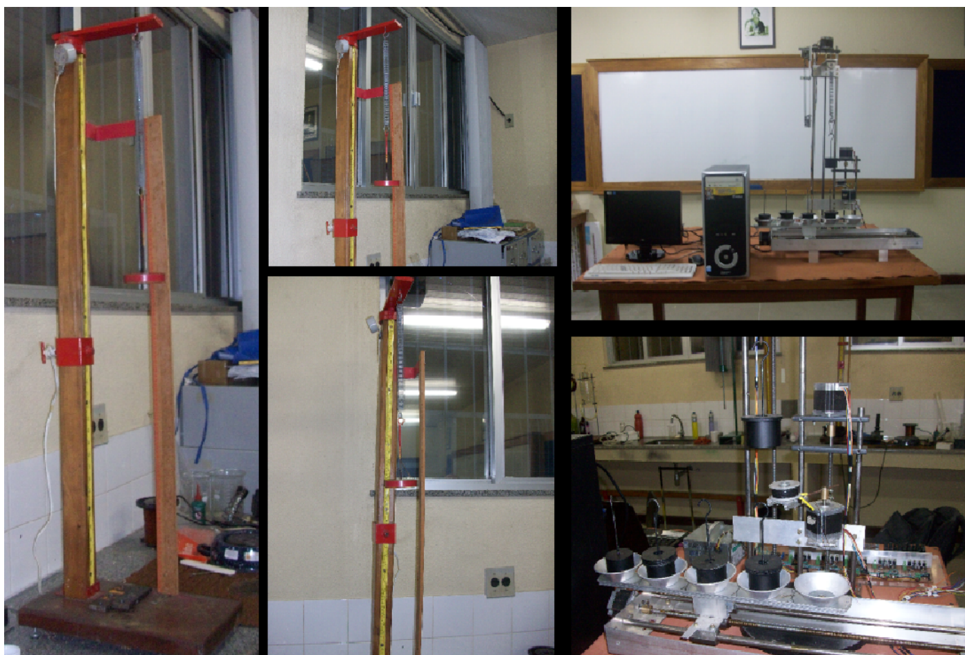
Conjunto de fotos 4 - Maquete do pêndulo mola e Maquete automatizada do pêndulo mola (em desenvolvimento)
