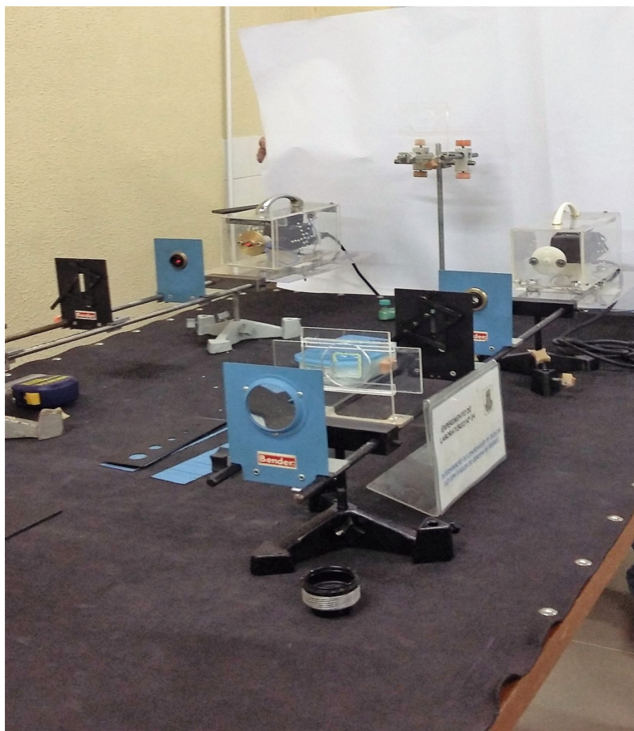
Foto 4 - Maquete experimental para a determinação do comprimento de onda da luz com a ajuda do biprisma de Fresnel
