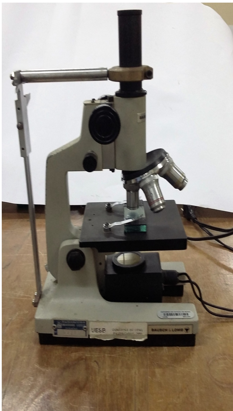
Foto 3 - Maquete experimental utilizada para a determinação do índice de refração de uma lâmina de vidro com o auxílio de um microscópio.
