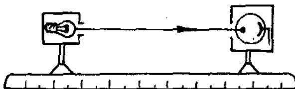
Fig. 3 - Maquete experimental para o estudo da dependência da fotocorrente da iluminação
