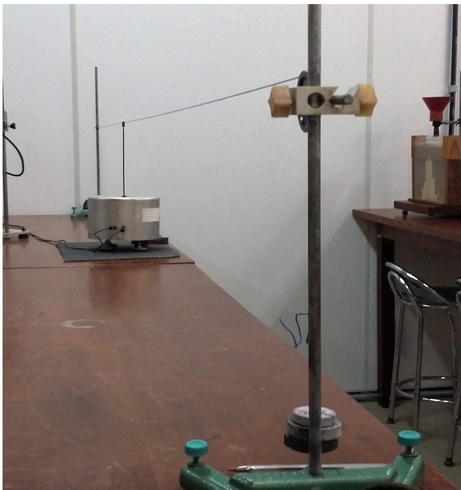
Foto 7 - Maquete experimental utilizada para o estudo das oscilações de um fio pelo método da ressonância
