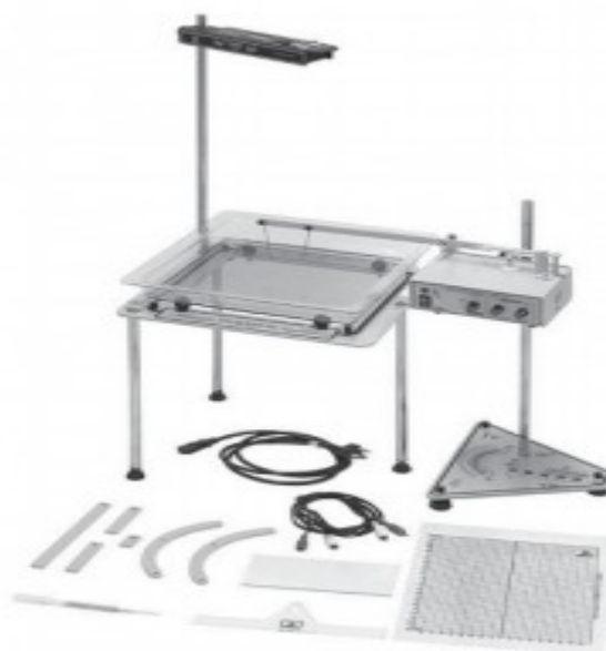
Fig. 5 - Cuba de ondas utilizada para a determinação da tensão superficial pelo método das ondas capilares gravitacionais (em desenvolvimento)
