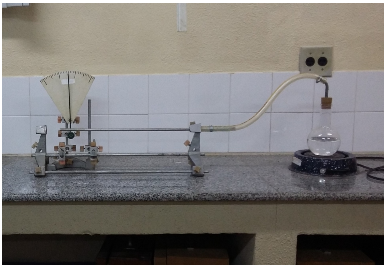
Foto 6 - Maquete experimental utilizada para a determinação do coeficiente de dilatação linear de um corpo metálico.
