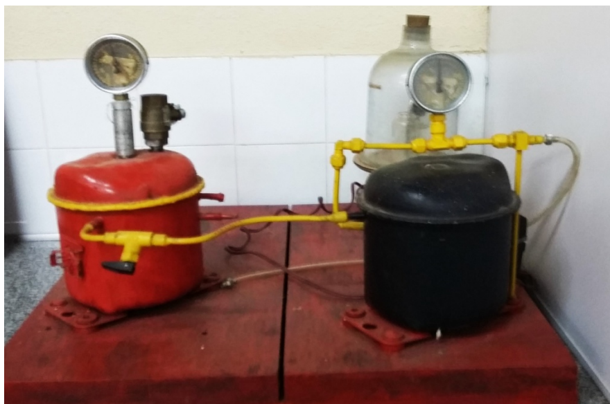
Foto 4 - Maquete experimental construída para o estudo de um ciclo termodinâmico.
