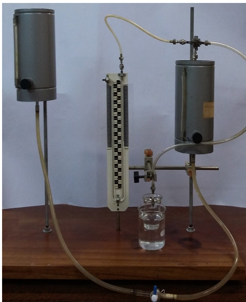
Foto 5 - Maquete experimental construída para a determinação da tensão superficial de um líquido pelo método da pressão máxima numa bolha.
