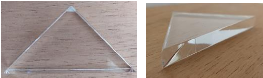
Figura 17: Prisma triangular de 45^\circ (prisma de reflexão total)
