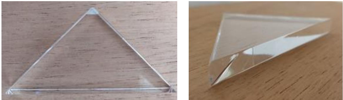
Figura 17: Prisma triangular de 45^\circ (prisma de reflexão total)
