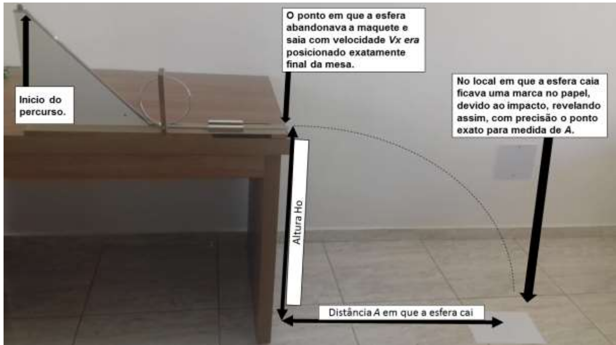
FIGURA 15 – Informações utilizadas na maquete para determinar V_x .
