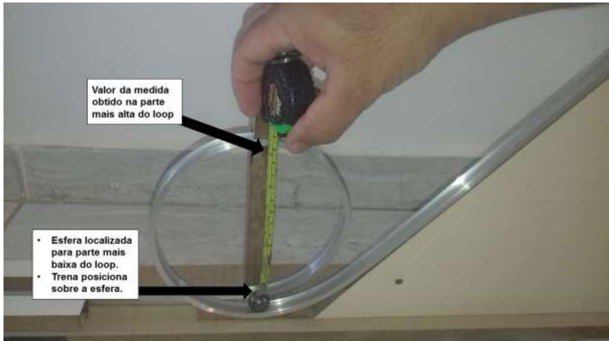
FIGURA 14 - Posicionamento para medida do looping.
