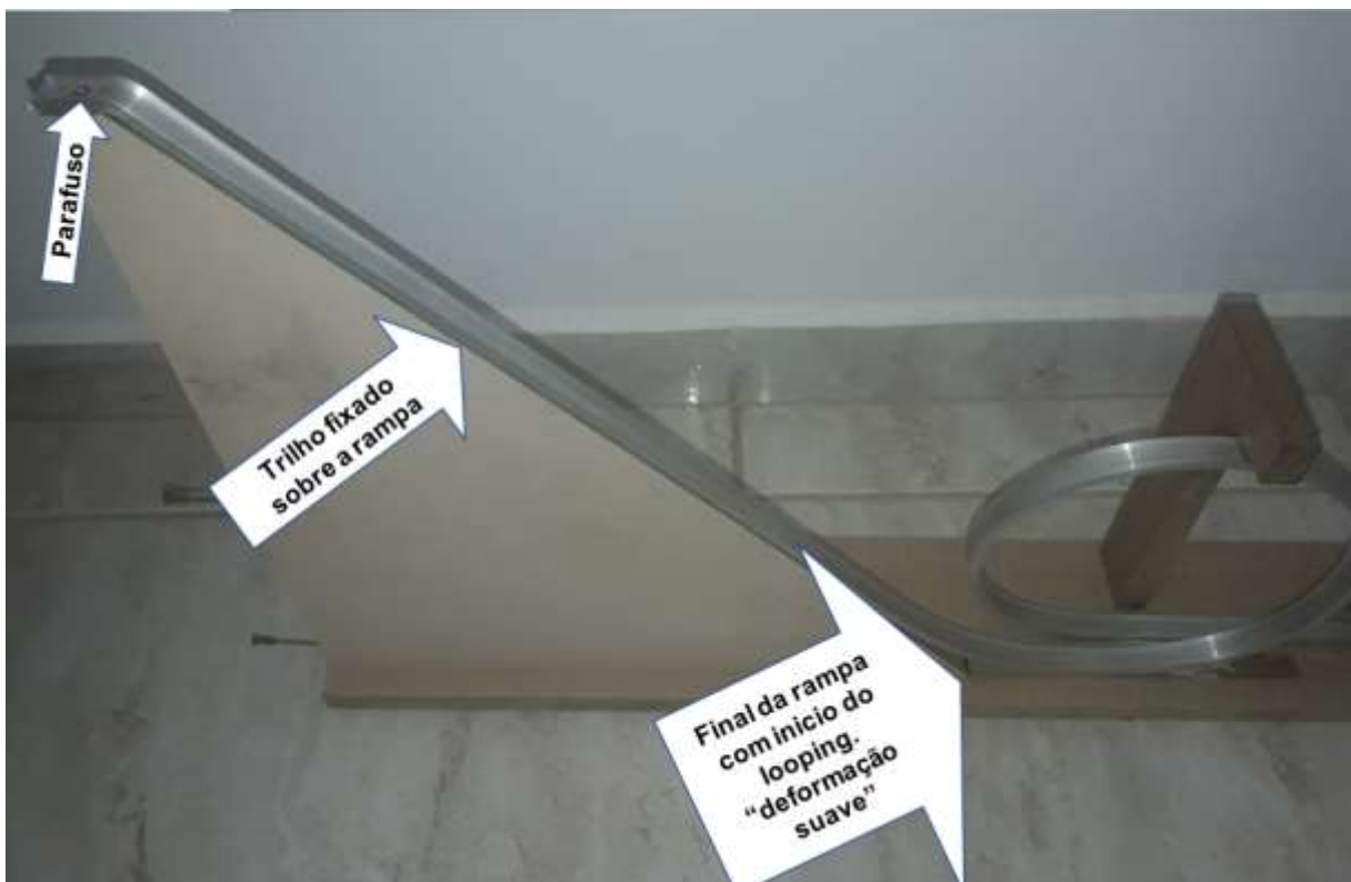
Figura 20 - Colagem do Trilho Sobre a Rampa
