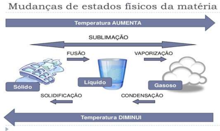
FIGURA 4: RELAÇÃO ENTRE A TEMPERATURA E AS MUDANÇAS DE FASE. DISPONÍVEL EM: HTTPS://WWW.RESUMOESCOLAR.COM.BR/QUIMICA/MUDANCAS-DE-ESTADO-FISICO-DA-MATERIA/ . ACESSO EM 25/09/2017.
