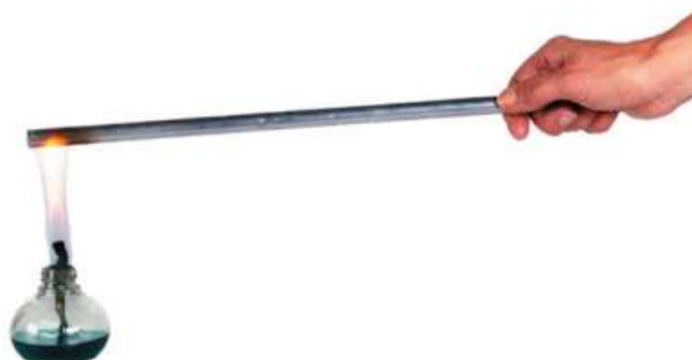
FIGURA 4: CONDUÇÃO TÉRMICA. DISPONÍVEL EM: HTTPS://UNIVERSOCIENTIFICO.COM.BR/1A-AULA-TERMOLOGIA-DEFINICAO-DE-CALOR-E-TEMPERATURA/ . ACESSO EM 20/09/2017.
