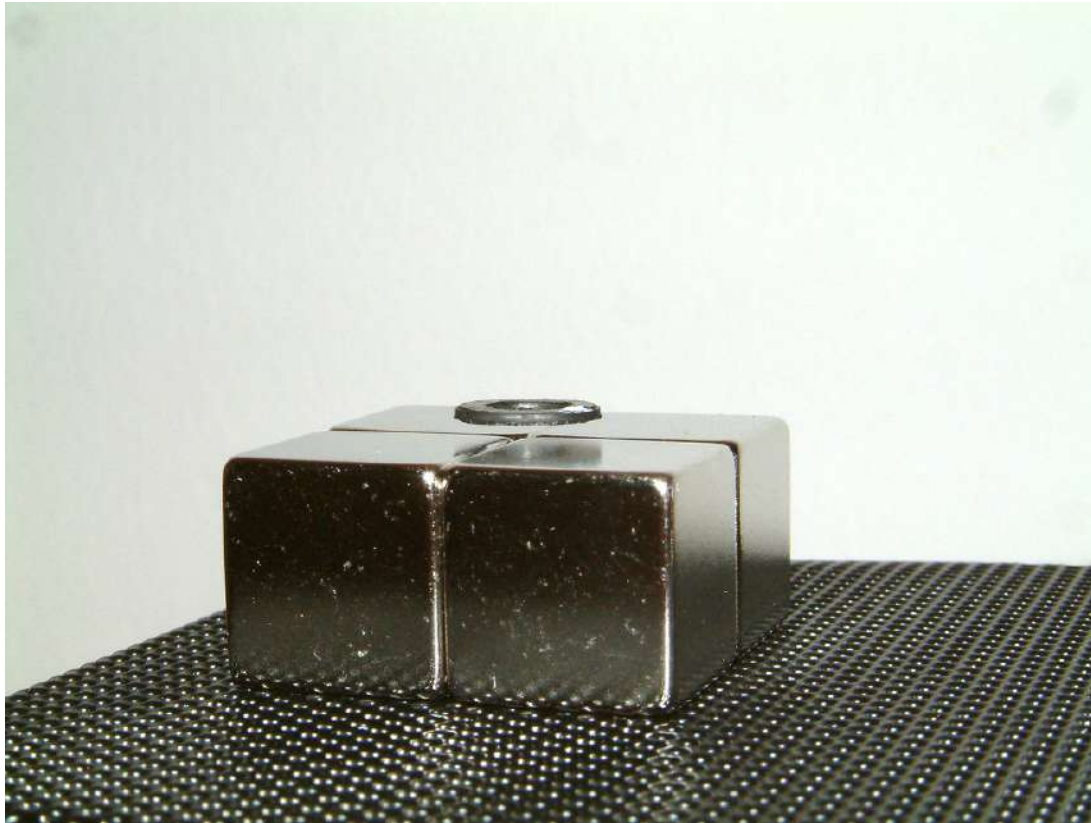
Figura 14 – Experimento demonstrando a levitação magnética do grafite. Fonte: https://hiveminer.com/Tags/graphite2Clevitation
