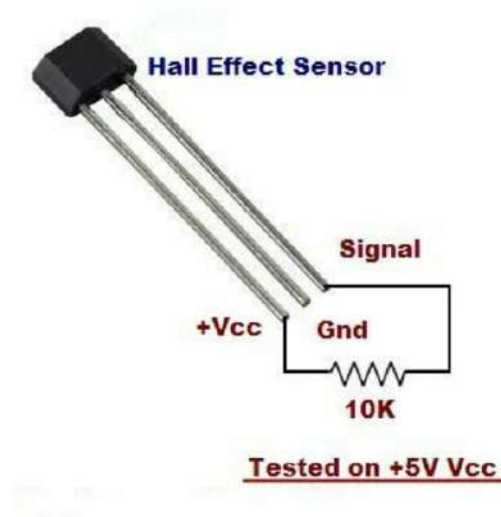
Figura 20 – Detectando campos magnéticos com o Sensor Hall.
