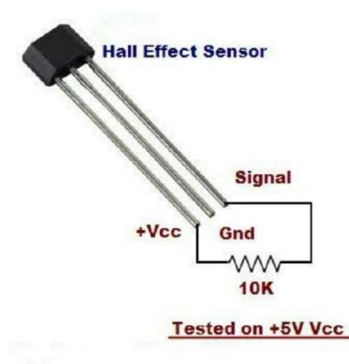
Figura 52 – Detectando campos magnéticos com o Sensor Hall.
