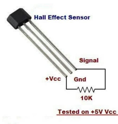
Figura 52 – Detectando campos magnéticos com o Sensor Hall.
