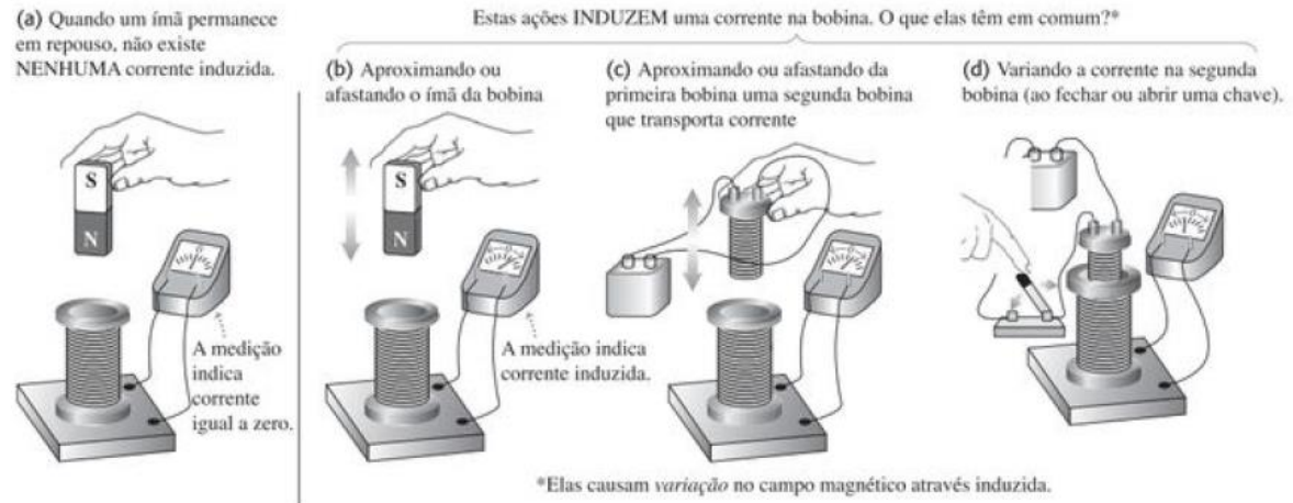
Figura 3 - Demonstração do fenômeno da corrente induzida
