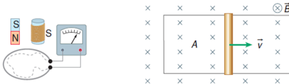
Figura 6 - variação de B através da variação da área da bobina atravessada pelo campo magnético.
