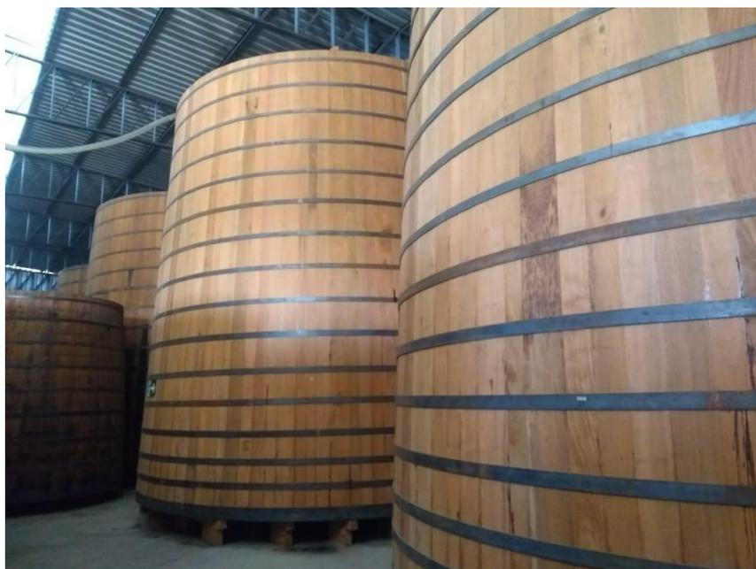
Figura 6 - Dornas de carvalho com capacidade para 150.000 litros onde a cachaça passa pelo processo de envelhecimento. Fonte: Acervo pessoal.
