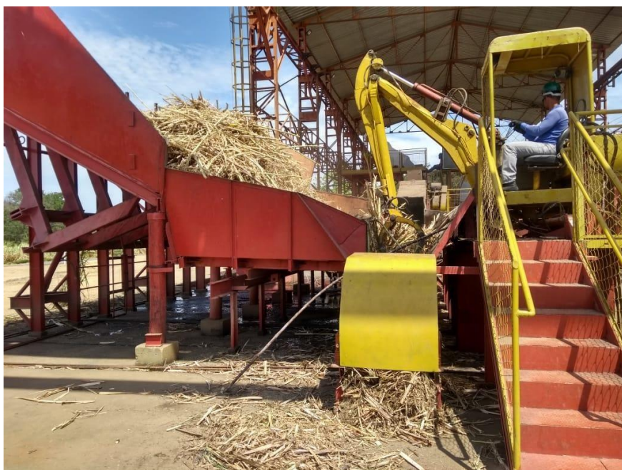
Figura 14 - Fase inicial do processo, cana sendo triturada
