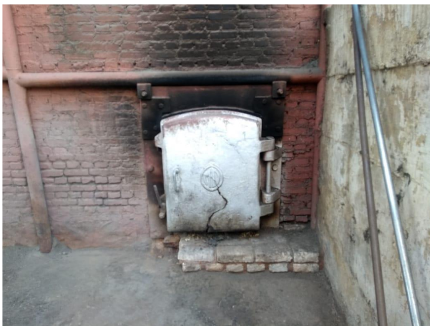
FIGURA 15 - Fornalha onde se realiza a queima de parte do bagaço produzido a partir da moagem da cana.
