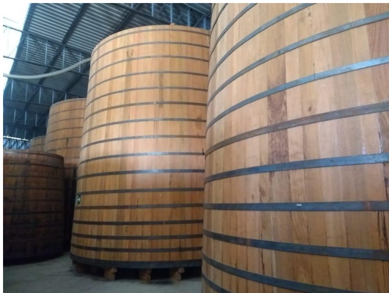
FIGURA 16 - Dornas de carvalho com capacidade de 150.000 litros, onde é envelhecida a cachaça Seleta.
