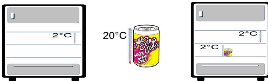
Figura 3 – A figura mostra que após certo tempo ocorre o equilíbrio térmico entre a lata e o refrigerador.
