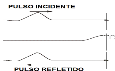
Figura 24 - Onda em uma corda com extremidade livre. Fonte: << https://www.sofisica.com.br/conteudos/Ondulatoria/Ondas/reflexao.php >>. Acesso em 22/02/2021.
