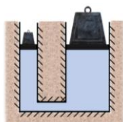
Figura 8 – Prensa hidráulica baseada no princípio de Pascal.
