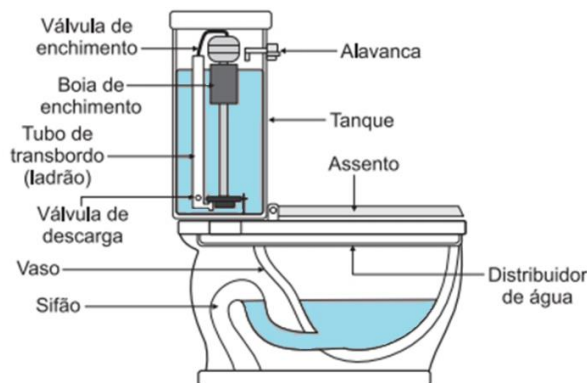
Figura 7 – Esquemática das partes de uma bacia sanitária com caixa acoplada.
