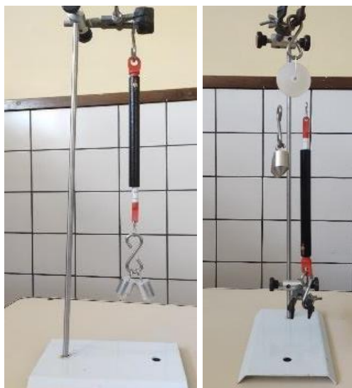
Imagem 7- Montagem final do sistema com roldanas
