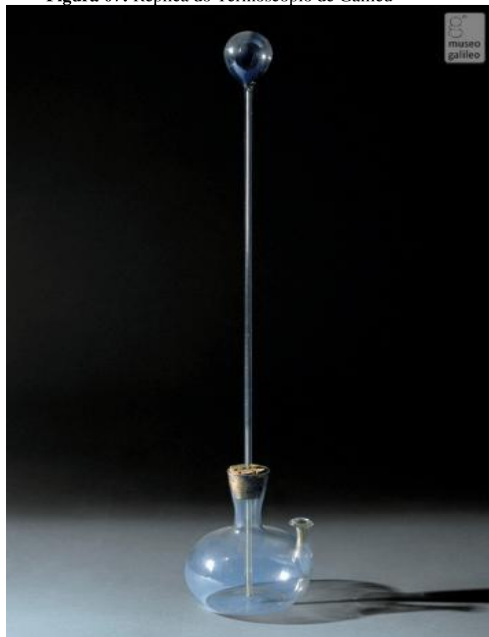
Figura 07: Réplica do Termoscópio de Galileu
