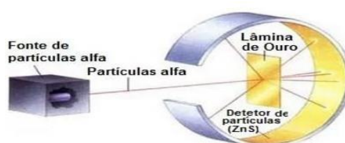
Figura 2: Aparato experimental utilizado por Rutherford
