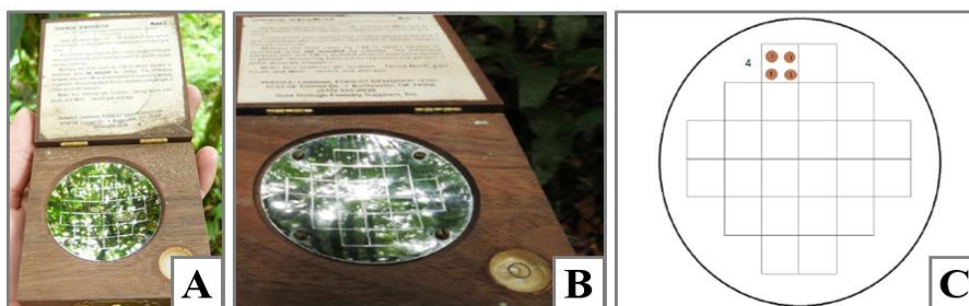
Figura 8 - Densiômetro florestal (A e B) e esquema da superfície de leitura do equipamento com os quatro pontos imaginários por quadro (C).
