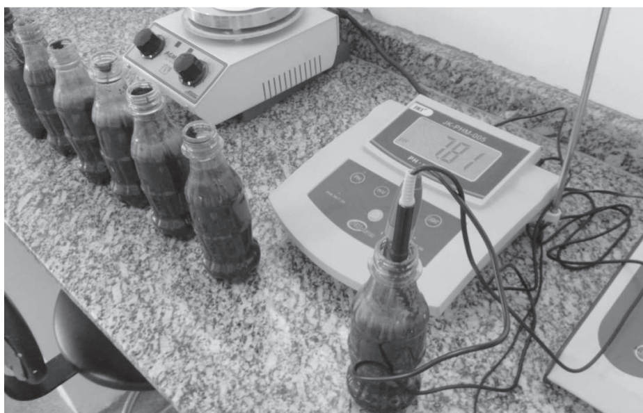
Figura 22: Determinação do pH em água dos substratos.
