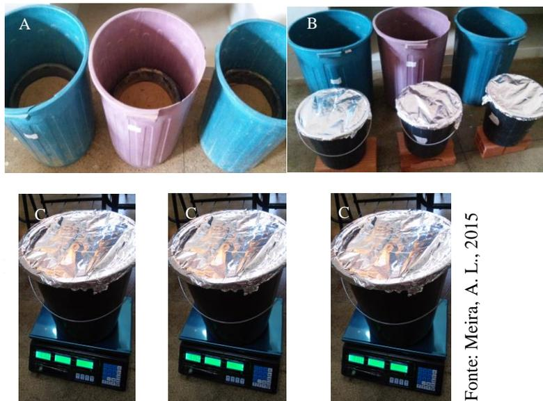
**Figura 1.2** – Determinação da capacidade de campo. A: imersão do vaso em água; B: retirada do vaso após 24 h; C: pesagem dos vasos. UESB, Vitória da Conquista-BA, 2015.
