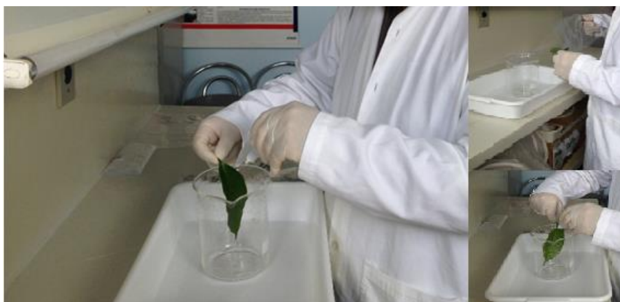
Figura 5 – Lavagem de folhas de café para estimativa do depósito do marcador Azul Brilhante. São Desidério, BA, 2016.
