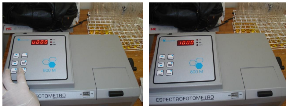
Figura 3 – Espectrofotômetro utilizado para realizar leituras de açúcares redutores e totais, em função das fontes e concentrações de potássio. UESB, Vitória da Conquista – BA, 2008.
