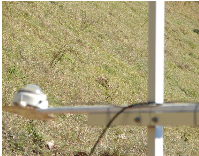
Figura 10 - Piranômetro da Unesp medindo a radiação solar na rampa.
