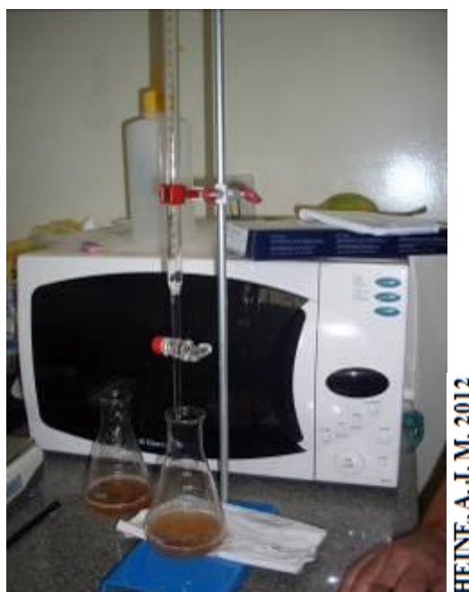
Figura 18 - Determinação da acidez titulável de tomate Lumi. UESB, Vitória da Conquista – BA, 2012.
