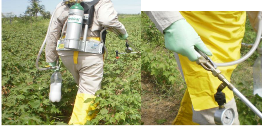
Figura 1 - Pulverizador costal manual de pressão constante (CO 2 ), utilizado no experimento. Vitória da Conquista, BA, 2010.
