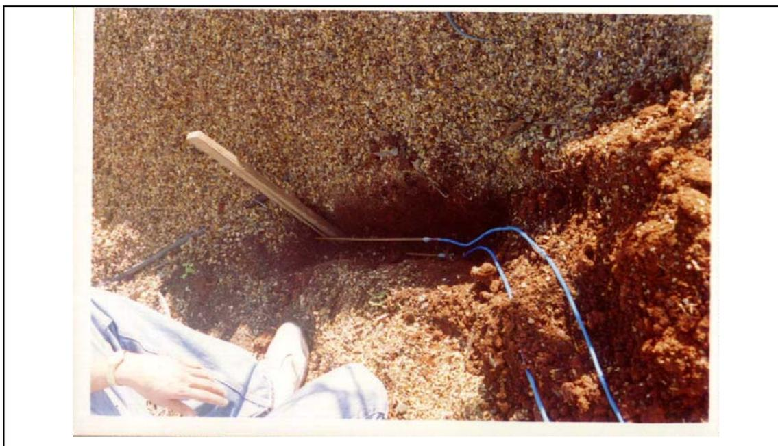
**Figura 3** - Posicionamento dos sensores de temperatura, no solo.
