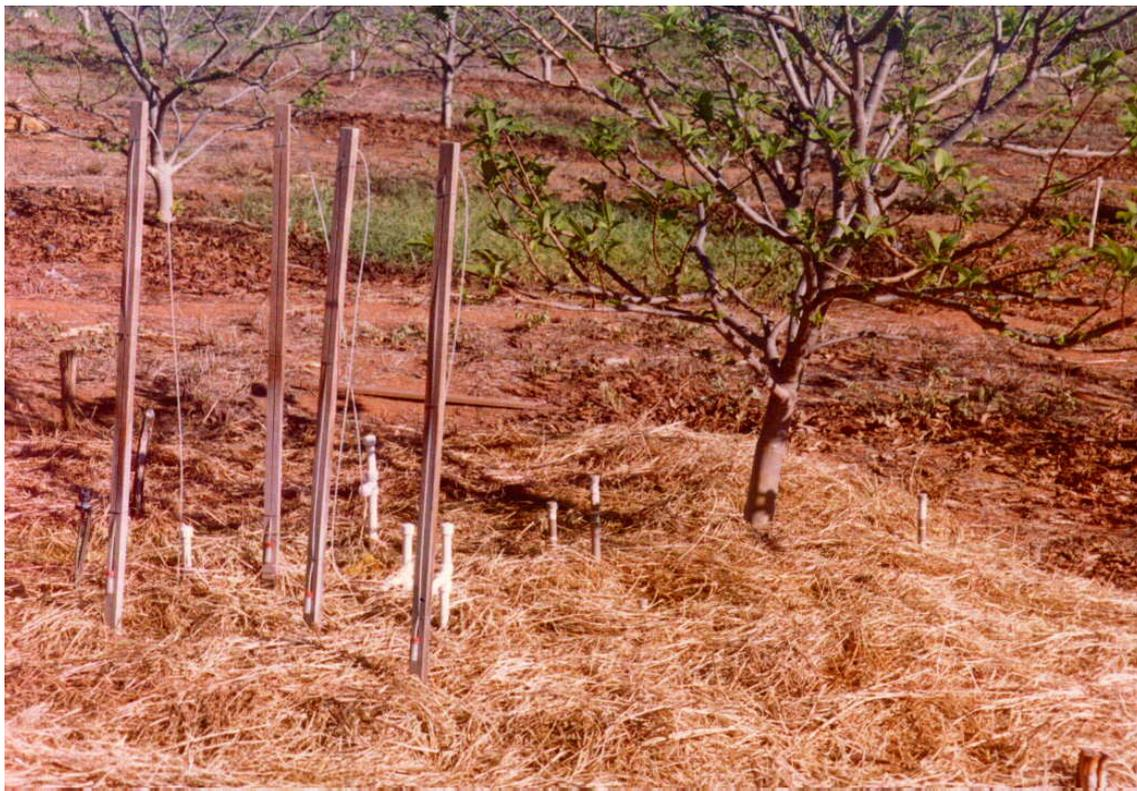
**Figura 10A** - Parcela experimental com palha de buffel, em detalhe o posicionamento dos tensiômetros (projeto piloto)
