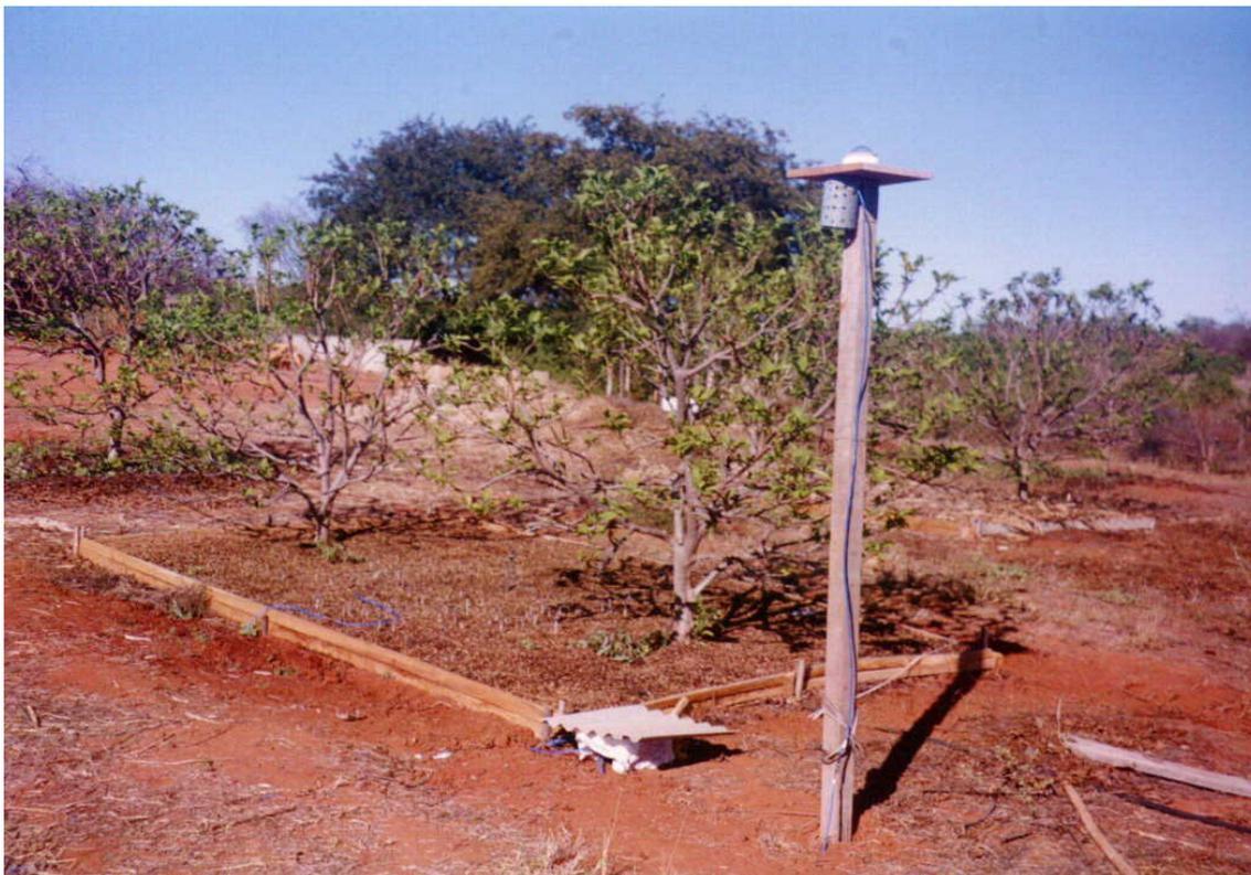
**Figura 6A** - Detalhe do sensor de temperatura ambiente, do piranômetro e da proteção do Datalogger em campo.
