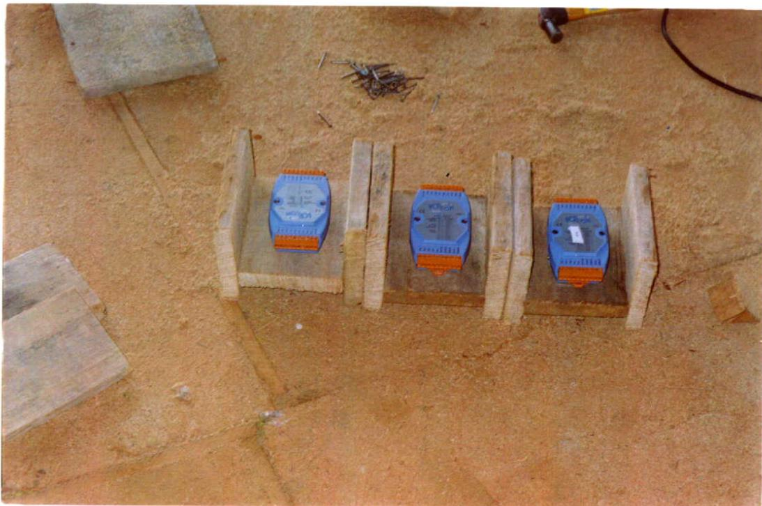
**Figura 5A** - Detalhe da proteção das Datalogger.
