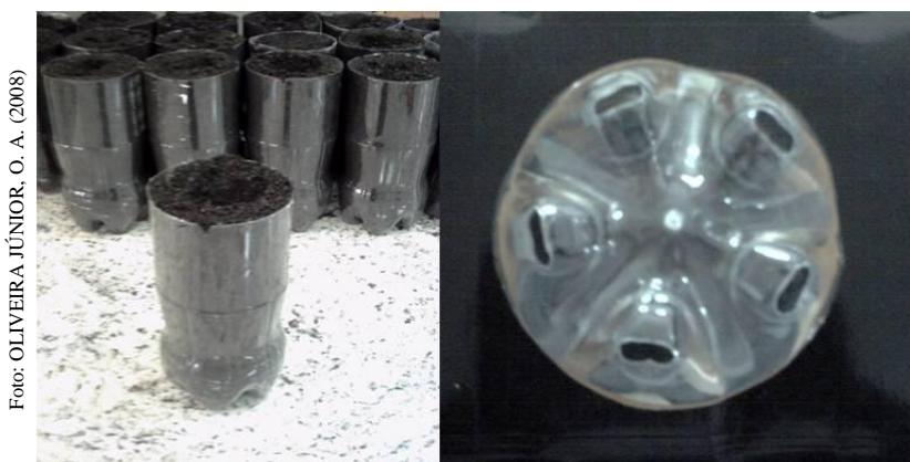
Figura 5 – Tubos confeccionados para a avaliação do Potencial de Regeneração de Raízes (PRR) de mudas de Eucalyptus urophylla .
