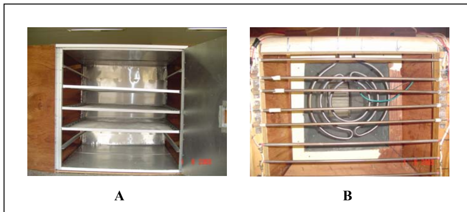
Figura 2 - Fotos do interior do secador: Câmara de secagem com 5 bandejas (A) e sistema de aquecimento (B).
