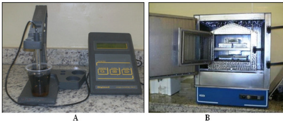
Figura 4 - Teste de condutividade elétrica (A); teste de envelhecimento acelerado (B). Vitória da Conquista BA, UESB, 2010.
