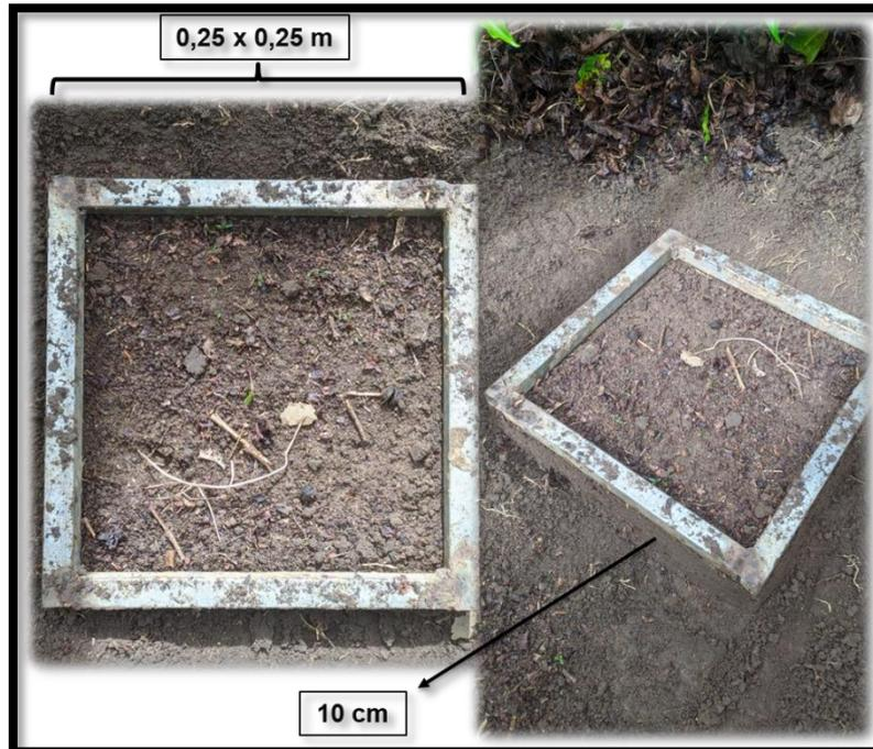
**Figura 3** – Monólito de solo coletado pelo método *Tropical Soil Biology and Fertility Programme* de 0,25x0,25m de largura e 10 cm de profundidade.
