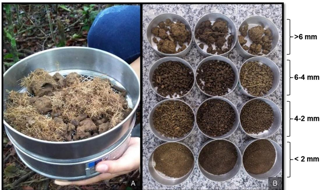
**Figura 2** – Representação do peneiramento seco realizado em campo (A) e amostras das classes de agregados obtidas a partir desse peneiramento (B).
