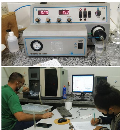
Figura 6 – Apresentação do procedimento de leitura de soluções: (a) Leitura de K em Fotômetro de chama; (b) quantificação nutricional de micronutrientes, Ca e Mg por meio do Espectrômetro de absorção atômica Varian.
